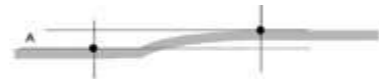
La valeur de déformation est la différence de hauteur A entre les deux points.
