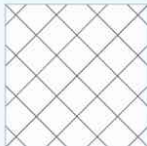
Square Format Installation at 45° Colocación formato cuadrado a 45°
